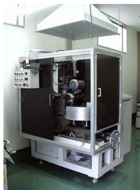
下:円弧状自動鋸目立て機械開発2号機
